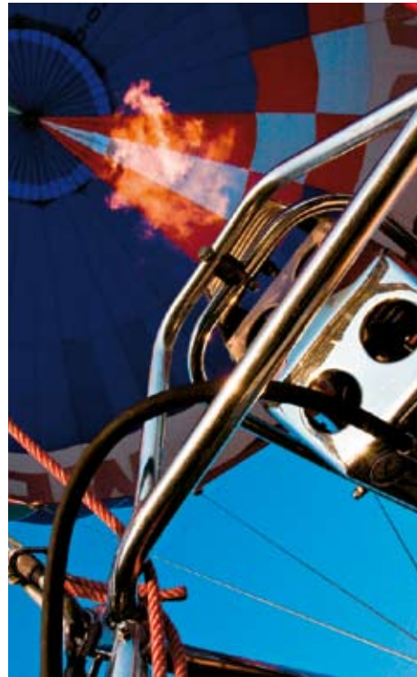
Der Brenner lässt den Ballon innerhalb kürzester Zeit um über hundert Meter steigen.
